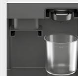
Емкость под воронкой для горячего фильтрования
